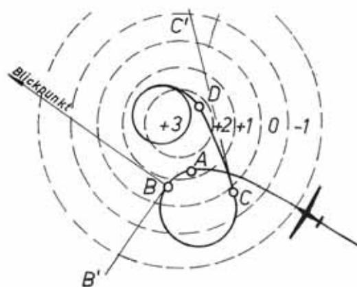
Bild 11: Zentrieren nach Maximalanzeige des Variometers nach [1]
